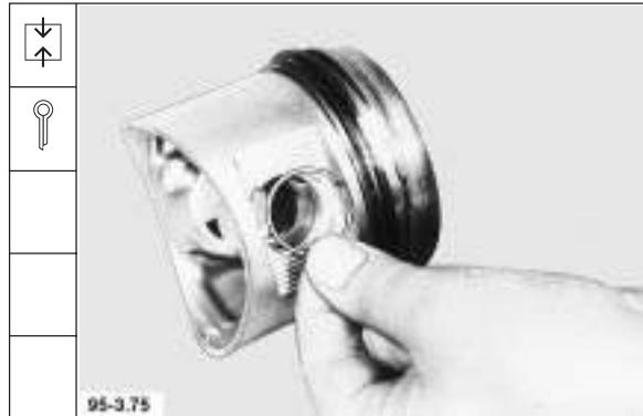
**Hinweis:** Ringstöße der Sicherungsringe müssen zum Kolbenboden zeigen.
