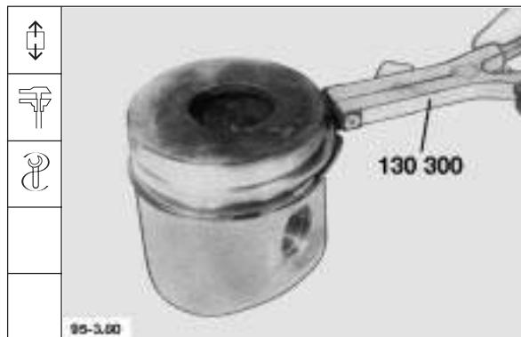
3. Kolben und Ringnuten reinigen und sichtprüfen.
