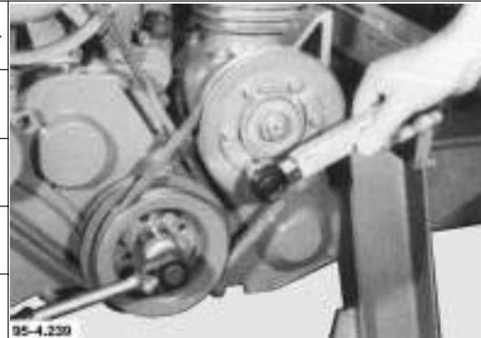
168. Keilriemenspannung prüfen.
