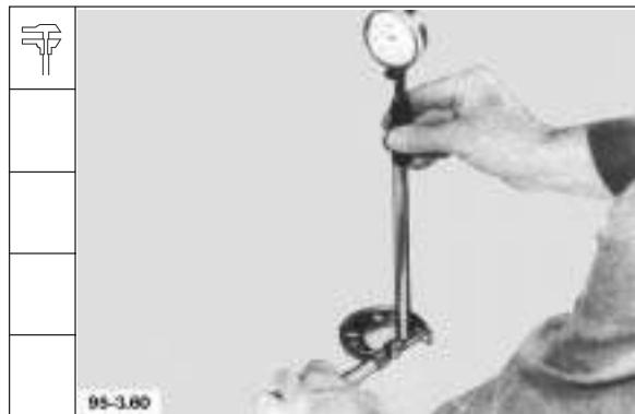
2. Kolbenbolzenbuchse an den Punkten „1“ und „2“ in der Ebene „a“ und „b“ -
