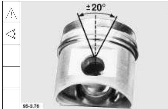
16. Kolben mit der Pleuelstange montieren.
