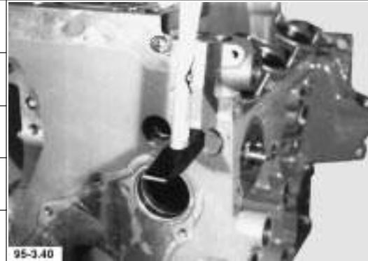
39. Regelstange mit Starterfeder in die Führungsbuchsen einsetzen.
