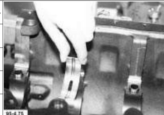
16. Lagerschalen in Hauptlagerdeckel einsetzen.
