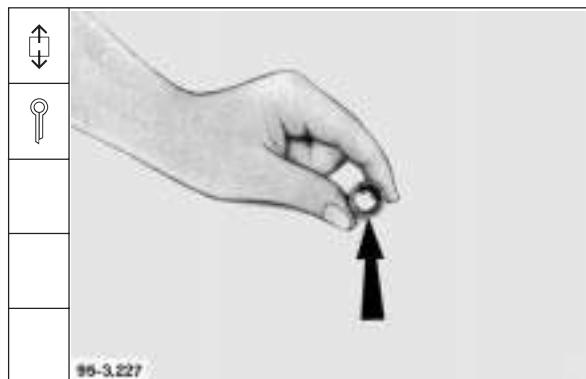
3. Sicherungsring entfernen.
