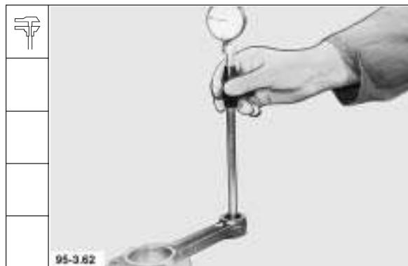
4. Bei Bedarf Kolbenbolzenbuchse auswechseln.
