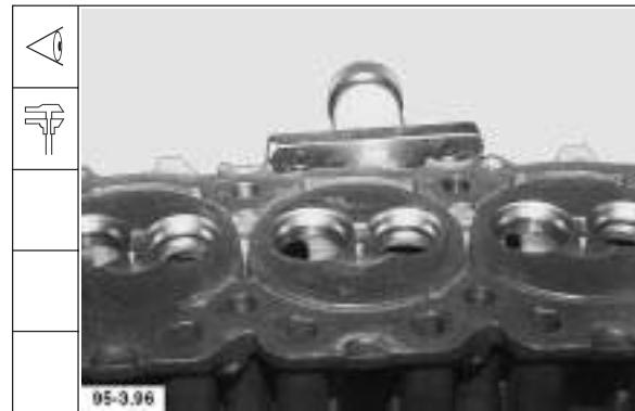
8. Ventilrückstand von der Mitte, Ventilteller zur Zylinderkopfdichtfläche messen.
