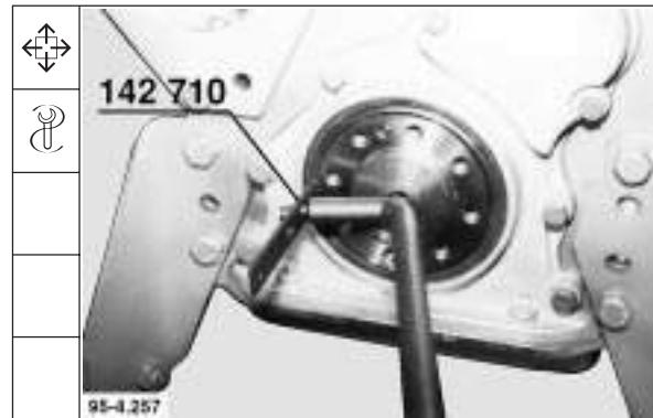
3. Wellendichtring ungeölt mit Montagevorrichtung montieren. Die Dichtlippe weist zur Kurbelwelle.
