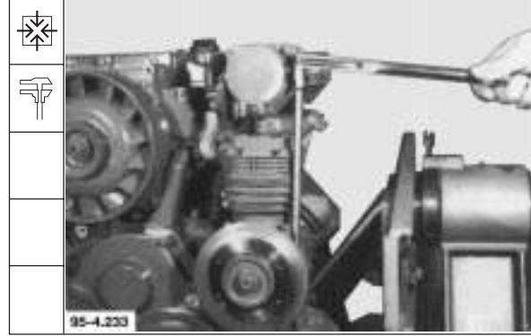
162. Schmierölleitung mit neuen Cu-Ringen anbauen. Schrauben festdrehen.
