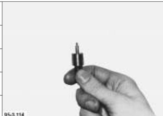
**Hinweis:** Bei ruckweisem Abgleiten der Düsenneedle die Einspritzdüse erneut in Dieselkraftstoff auswaschen, bei Bedarf erneuern.
