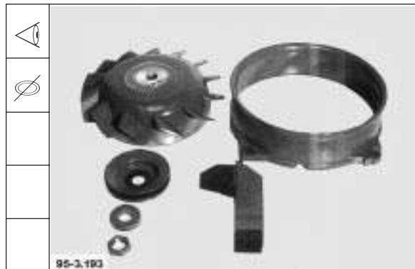
10. Generator in Kühlgebläse einsetzen.
