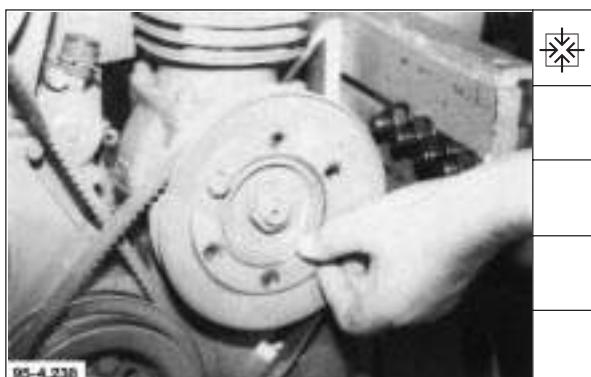
166. Falls vorhanden, restliche Ausgleichscheiben aufsetzen. Schrauben einschrauben.
