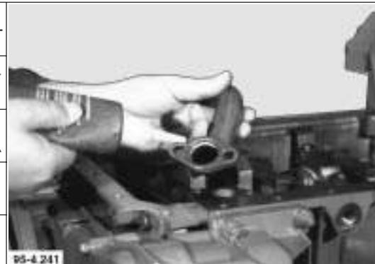
170. Ölansaugrohr anbauen. Schrauben festdrehen.
