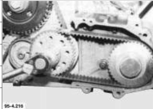
145. Zahnriemenspannungs-Meßgerät aufsetzen. Riemenspannung messen.
