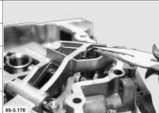
56. Deckel mit neuer Dichtung montieren.
