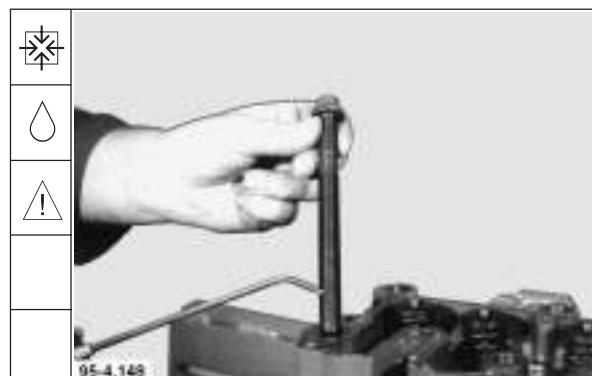
79.1 Zylinderkopfschrauben festdrehen.
