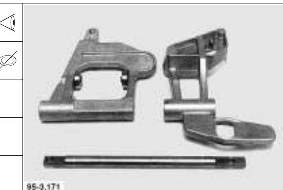
48. Rollenhebel, Welle und Leerlaufhebel sichtprüfen, ggf. austauschen.
