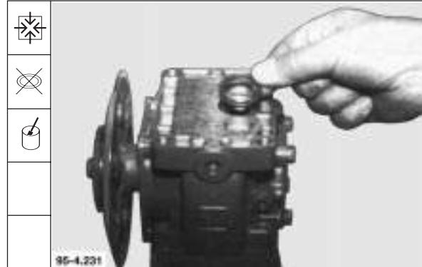
160. Luftpresser aufbauen und in Pfeilrichtung auf Anlage drücken.
