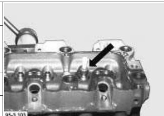
13. Schutzhülse entfernen. Ventilschaftabdichtung bis Anschlag eindrücken.
