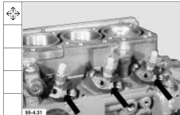
32. Rollenstößel für Einspritzpumpe (mit Hilfe einer Außensicherungszange) herausnehmen.
