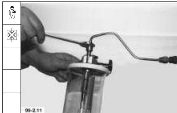
**2. Prüfung des Öffnungsdruckes**
