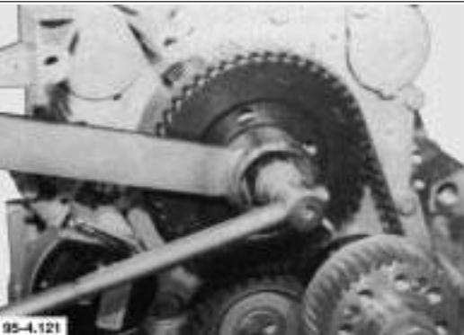
61. Zahnriemenspannungs-Meßgerät abnehmen. Einstellbolzen für Nocken- und Kurbelwelle entfernen.
